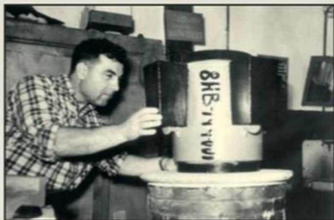
Рабочий М.А. Старчеусов изготавливает модель для точного литья корпуса топливного насоса
