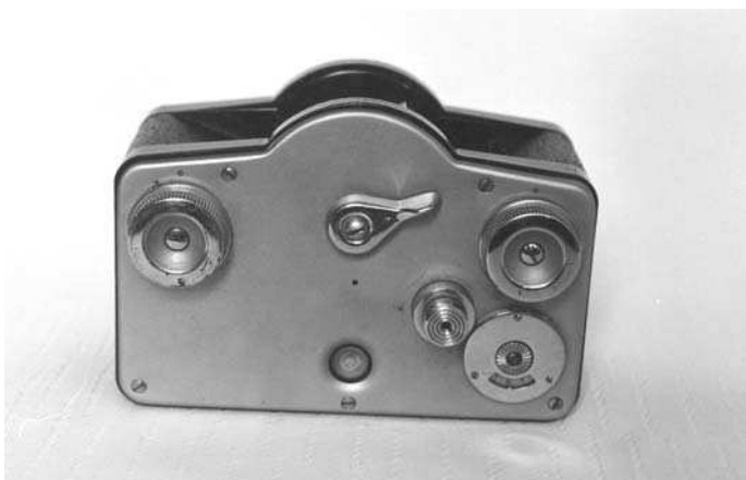
Панорамная Фотокамера ФТ-1. Из-за дороговизны в производстве была выпущена весьма ограниченной серией.
