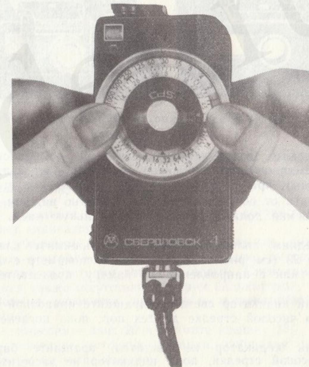
Рис. 3. Установка шкалы светочувствительности
