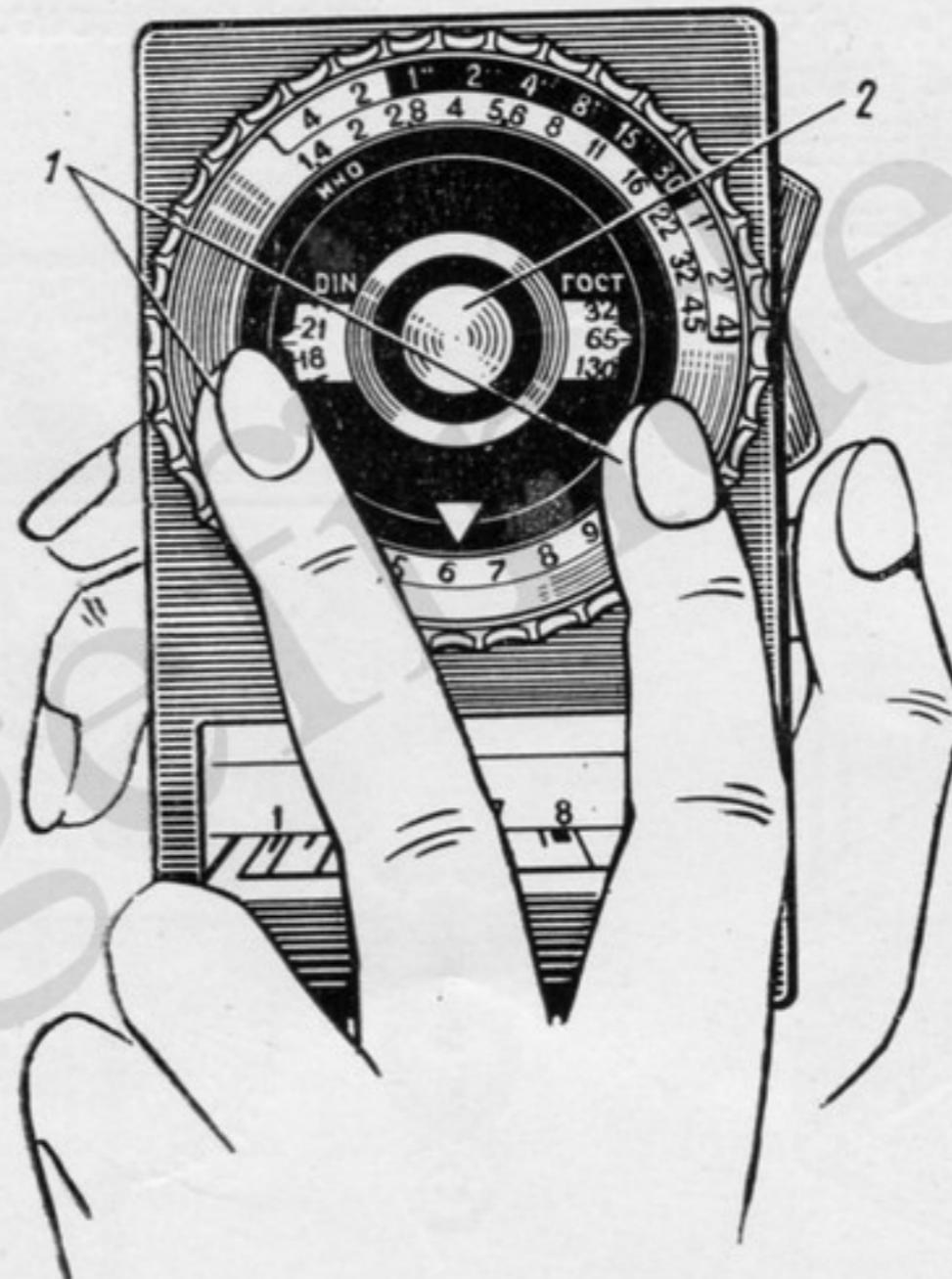
2. Направьте экспонометр в зависимости от метода определения условий экспонирования либо на фотографируемый объект, либо на фотоаппарат.
