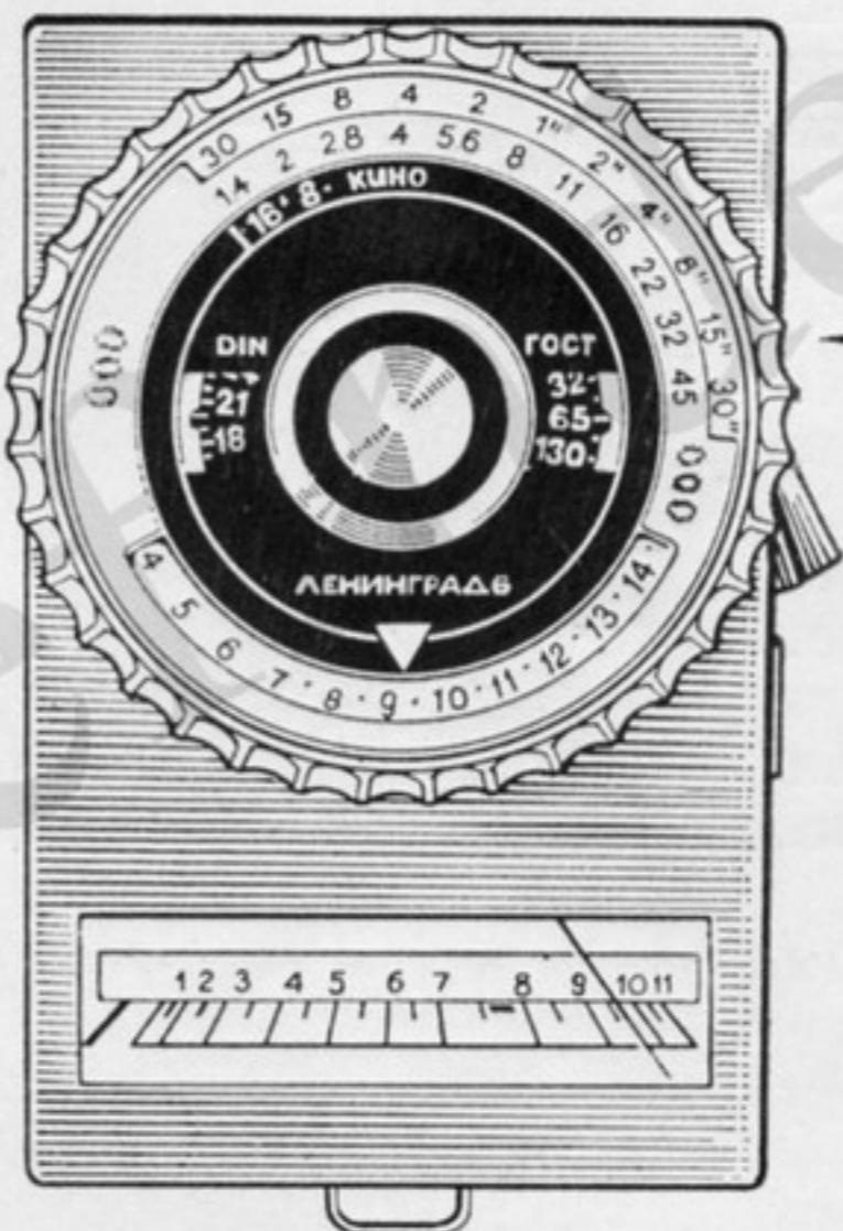
4. Если отклонение стрелки по шкале измерителя не достигает отметки „11“, нажмите на верхнюю часть клавиши и придержите ее несколько секунд, в результате чего перейдете на более чувствительный, т. е. первый диапазон измерений (усилие при нажатии на верхнюю часть клавиши должно быть несколько больше, чем на нижнюю).
