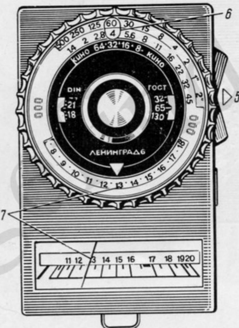
6. Установите вспомогательную шкалу поворотом кольца так, чтобы неподвижный указатель занимал на ней такое же положение, как стрелка на шкале измерителя.
