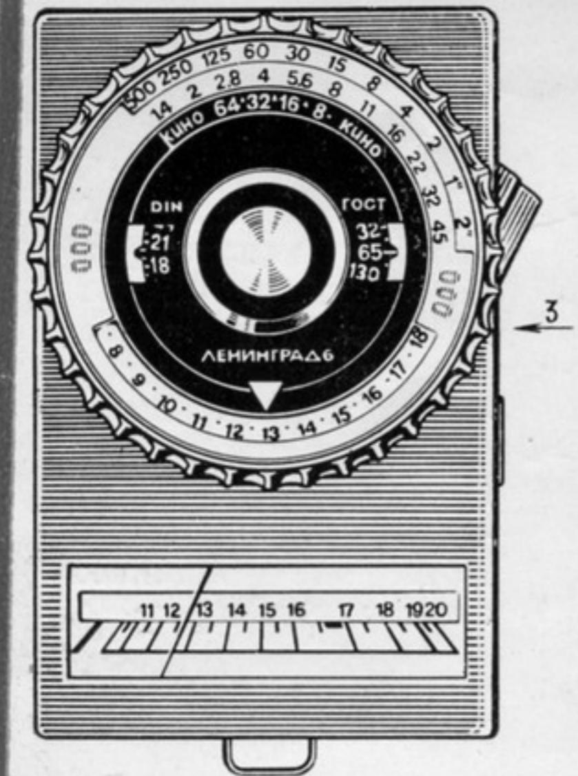
3. Нажмите плавно до упора на нижнюю часть клавиши и придержите клавишу в этом положении несколько секунд.
