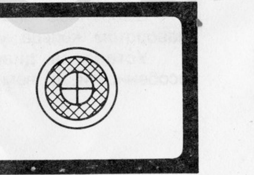
случаях, когда наводка на резкость производится при значениях диафрагмы больше 4. Здесь, а также при микро- и макросъемках, для наводки на резкость следует пользоваться кольцевым полем матовой поверхности.
