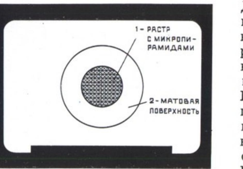
Для достижения наилучшей резкости на водку рекомендуется производить при полностью открытой диафрагме. Наилучшая резкость получается, когда изображение видно отчетливо, без явлений рябизны в поле микрораstra.
