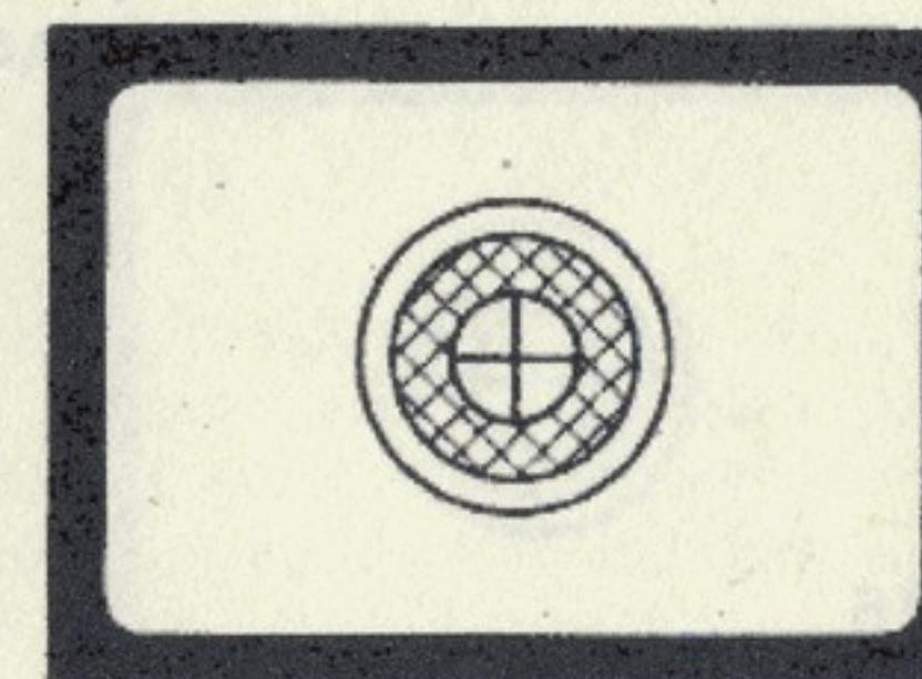
в тех случаях, когда наводка на резкость производится при значениях диафрагмы больше 4. Здесь, а также при микро- и макросъемках, для наводки на резкость следует пользоваться кольцевым полем матовой поверхности.
