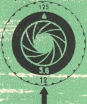
Если же по условиям съемки необходимо выделить какой-либо предмет без резкого фона, то следует уменьшить глубину резкости, установив диафрагму, например, 1:5,6. Это будет соответствовать выдержке 1/125 сек.
