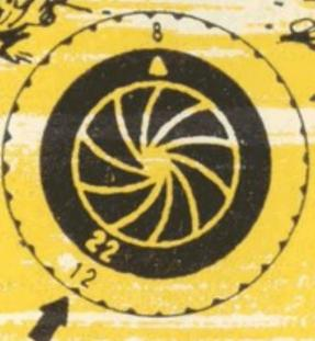
Установим, например, рычаг-указатель против деления «12» экспозиционной шкалы. Для фотографирования пейзажа требуется значительная глубина резкости. Поэтому поворачиваем регулировочное кольцо до совмещения рычага-указателя с делением «22» шкалы диафрагм. Индекс шкалы выдержек автоматически установится против деления «8».
