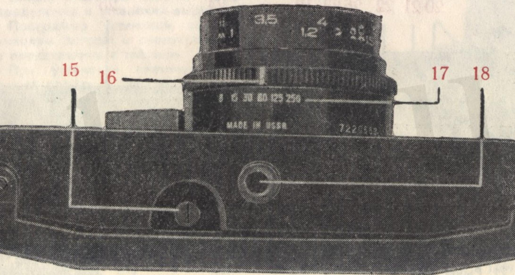
15. Кнопка отключения механизма перемотки пленки.
