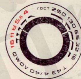
При фотографировании по шкалам выдержка устанавливается по шкале, расположенной в нижней части тубуса объектива, вращением кольца установки символов погоды (выдержек). Необходимое значение диафрагмы устанавливается вращением кольца установки диафрагмы, расположенного на передней части объектива, относительно шкалы.
