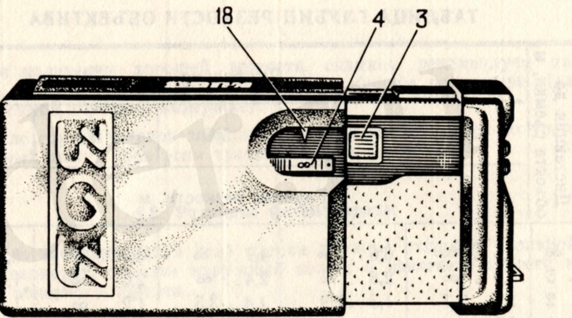
Спуск затвора производите плавным нажатием кнопки 3.
