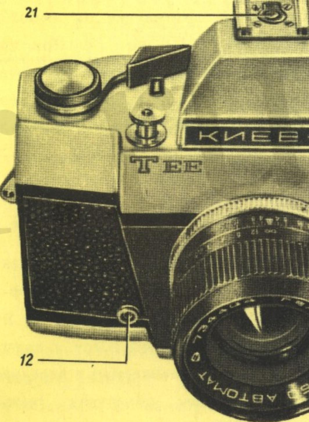
вспышек. Съемку с лампой-вспышкой следует производить только при отключенной автоматике на любой из выдержек от  $1/60$  до  $1/2$  с. При подключении лампы-вспышки через штепсельное гнездо 12 в обойму 21 необходимо вставить пластмассовый вкладыш для изоляции контакта.
