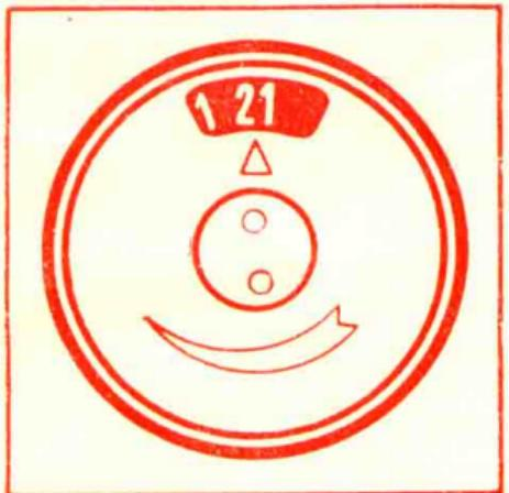
11. Установите счетчик кадров на цифру 21. Для этого надо поднять головку взвода до упора. Затем, вращая нижний диск, совместите цифру 21 с индексом, находящимся на головке взвода.
