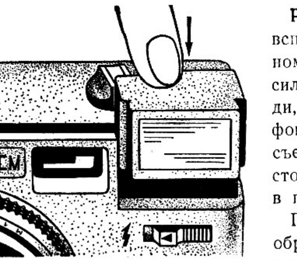
Рекомендуем съемку с лампой-вспышкой производить при дневном свете, если объект съемки сильнее освещен сзади, чем спереди, или при съемке объектов на фоне окна. При дневном свете при съемке с лампой-вспышкой расстояние до объектов должно быть в пределах от 1,1 до 2,5 м.
