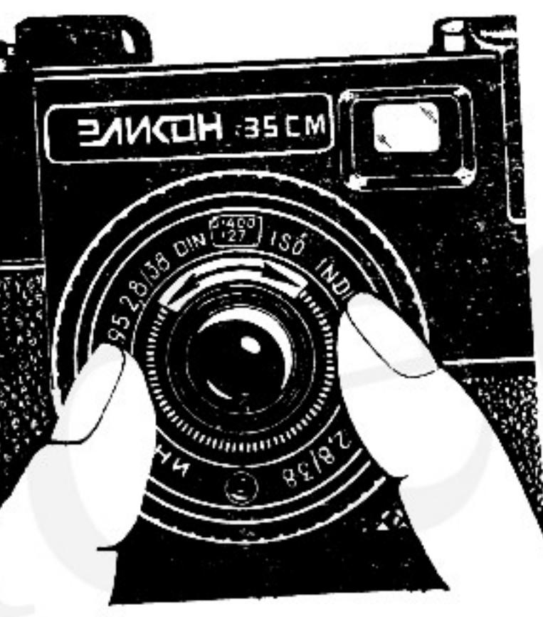
Светочувствительность фотопленки указана на ее упаковке. Для учета светочувствительности экспонометрическим устройством фотоаппарата, введите ее значение, развернув установочное кольцо б до момента появления в центре индикаторного окна 10 значения светочувствительности, соответствующего значению, указанному на упаковке фотопленки.
