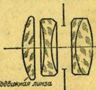
методом фокусирования, заключающимся в передвижении передней линзы. Это передвижение осуществляется путем вращения оправы, которая снабжена многозаходной нарезкой. На оправе нанесена шкала. Такой метод фокусирования позволяет создать более легкую конструкцию, чем например при фокусировании путем выдвижения всего объектива. Расчет объектива обеспечивает резкое и доброкачественное изображение при наводке от бесконечности до 1,5 м.
