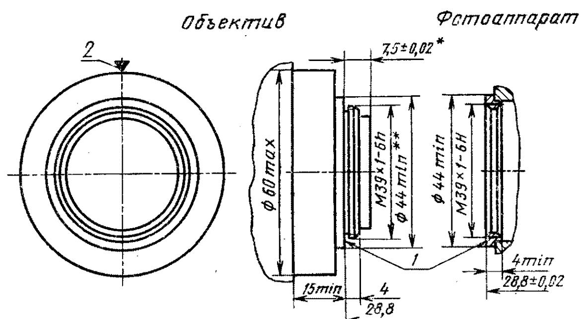
\* — в зоне  $\pm 10^\circ$  от индекса шкалы при установке на  $\infty$  для вращающегося дальномерного торца;
