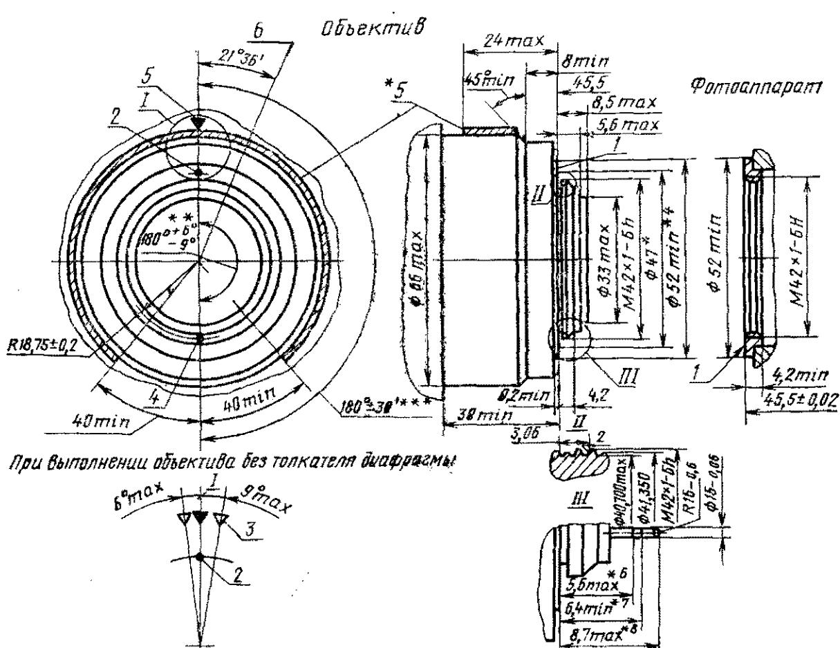
\* — диаметр площадки для определения размера 3,06 мм на резьбе;
