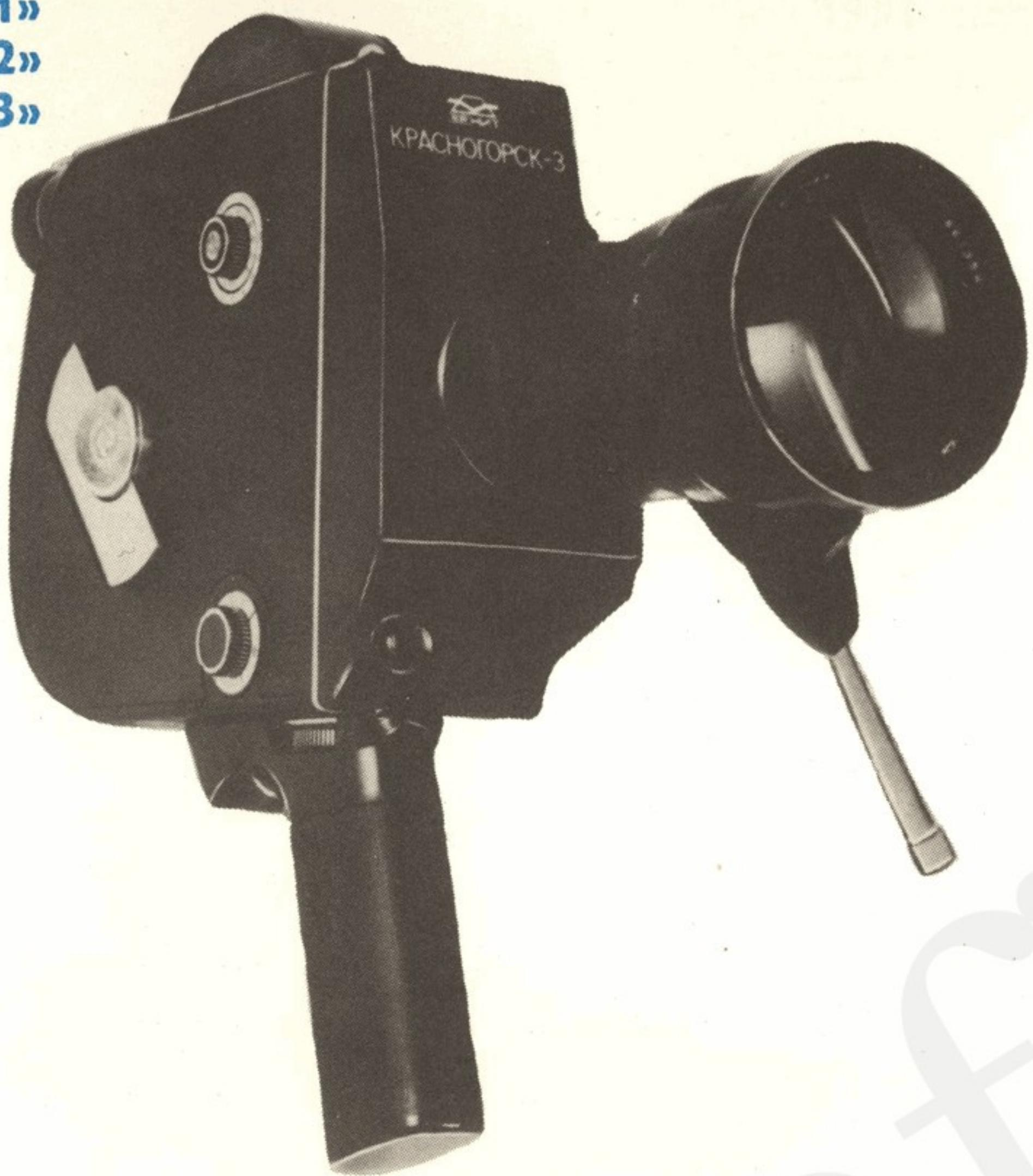
Киносъемочные аппараты, рассчитанные на применение 16-мм пленки. Формат кадра  $10,2 \times 7,6$  мм. Частота съемки 8, 12, 16, 24, 32, 48 с<sup>-1</sup> и покадровая. Установка экспозиции полуавтоматическая через съемочный объектив. Привод кинокамеры пружинный.
