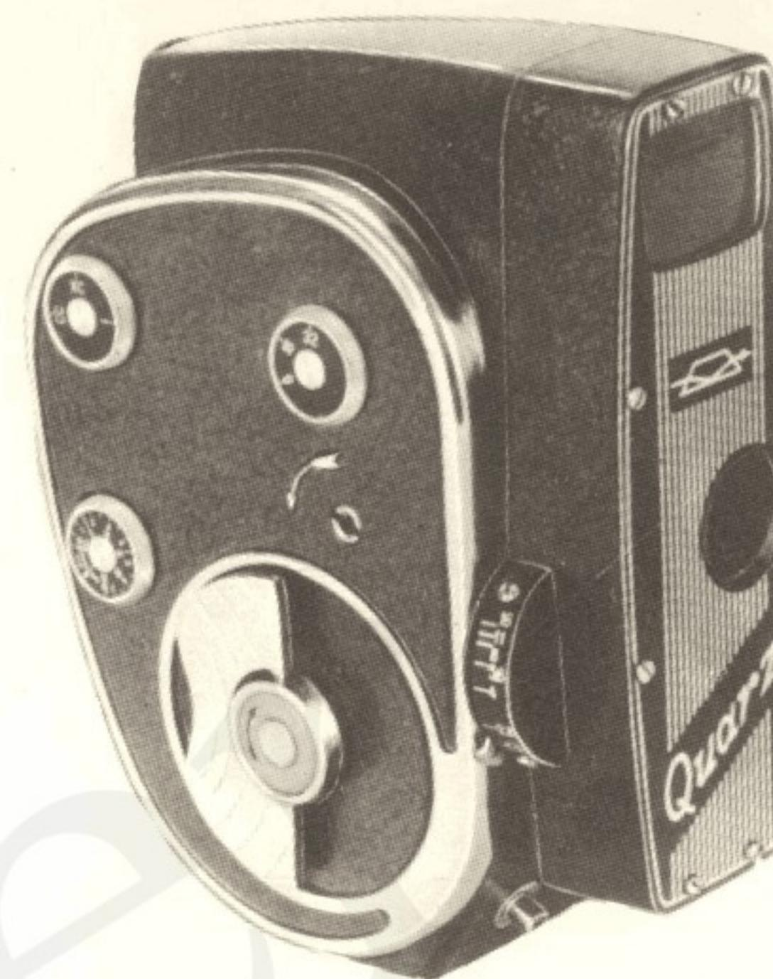
Киносъемочные любительские аппараты, рассчитанные на применение 16-мм пленки ( $2 \times 8$ ), формат кадра  $3,55 \times 4,9$ , частота съемки 8, 12, 16, 24, 32 с<sup>-1</sup> и покадровая. Объектив «Юнипер-24М» с  $F=12,5$  мм, относительным отверстием 1:1,9 и насадками 0,5 $\times$  и 2 $\times$ .
