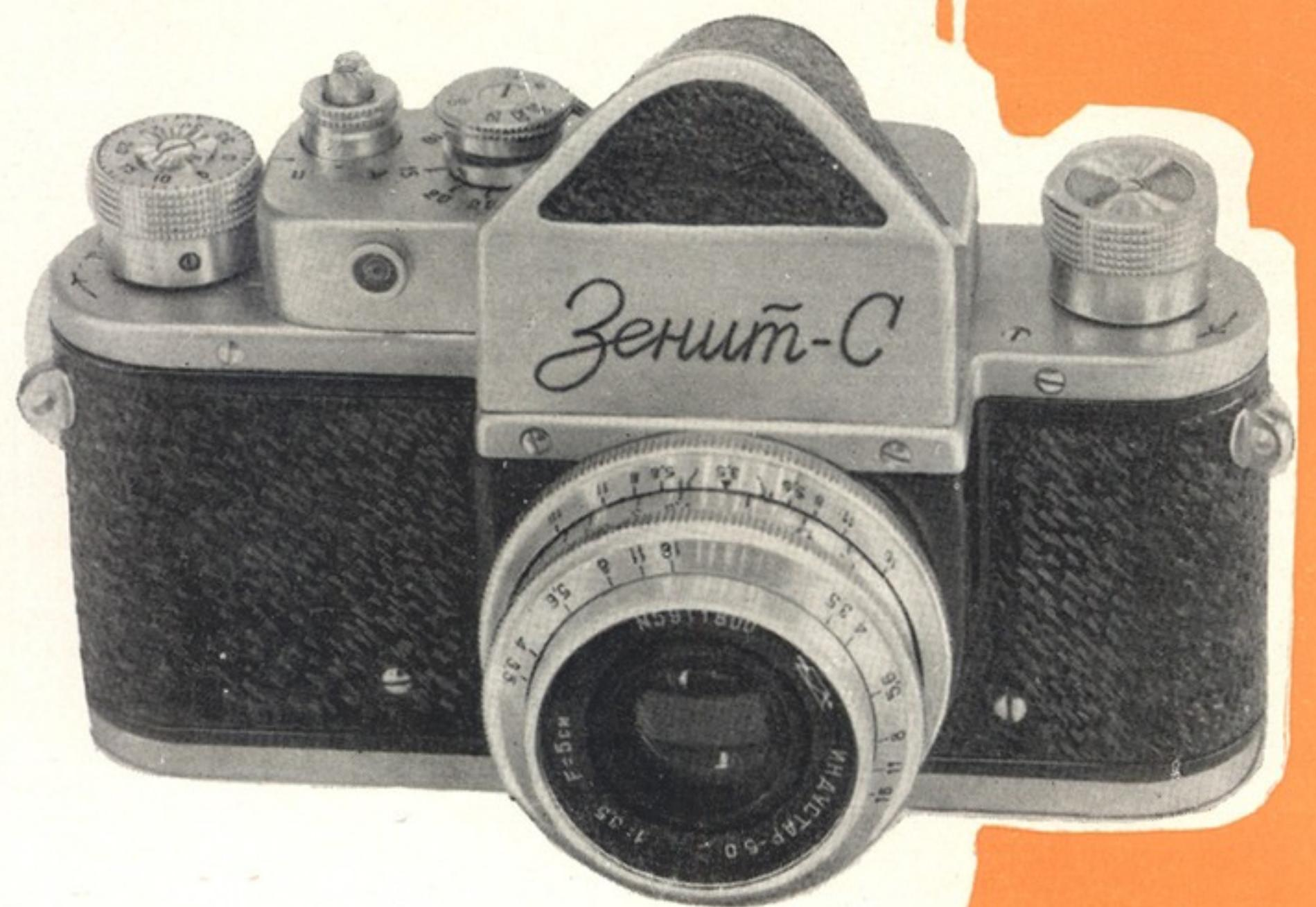
«Зенит-С» — малоформатный зеркальный аппарат с призменным телескопическим видоискателем, дающим на матовом стекле прямое изображение объекта, получаемое при помощи съемочного объектива и передающей системы с зеркалом. В момент съемки зеркало автоматически откидывается.
