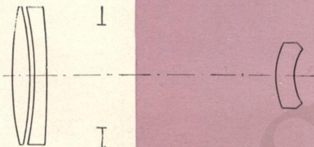
«Тайр-3» — светосильный объектив с просветленной оптикой. Обладает весьма высокой разрешающей способностью как в центре, так и по краям поля. Объектив снабжен присовой диафрагмой.
