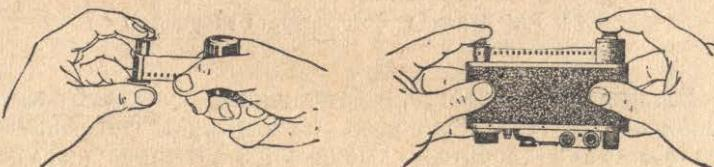
Рис. 77. Закрепление пленки в приемной кассете
