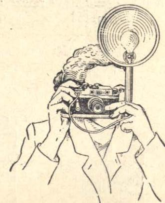
Рис. 44. Лампа-вспышка одноразового действия
