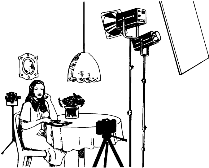
Рис. 22. Схема расположения осветительных приборов при съемке портрета с отделением снимаемого объекта от фона: 1 – отражающий экран, 2 – осветительные приборы, 3 – фотоаппарат, 4 – объект съемки
