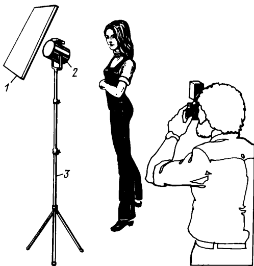
Рис. 21. Съемка портрета с использованием одного осветительного прибора: 1 — отражающий экран, 2 — осветительный прибор, 3 — штатив
