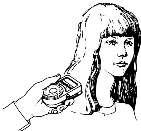
Рис. 18. Измерение наиболее освещенной части лица при съемке портрета
