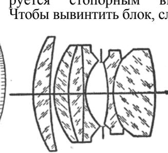
Рис. 200. Оптическая схема объектива «Юпитер-8».
