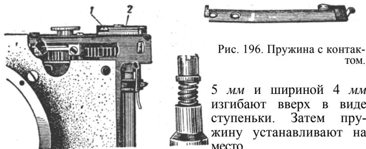
Рис. 196. Пружина с контактом.
