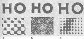
Рис. 8. Сильно увеличенный текст и фрагменты репродукций полутонных оригиналов, выполненных способами: а — высокой; б — глубокой; в — офсетной печати
