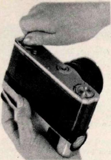
Рис. 4. Відкривання замків на задній стінці.
