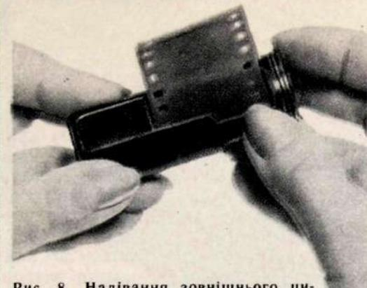
Рис. 8. Надівання зовнішнього циліндра на внутрішній.
